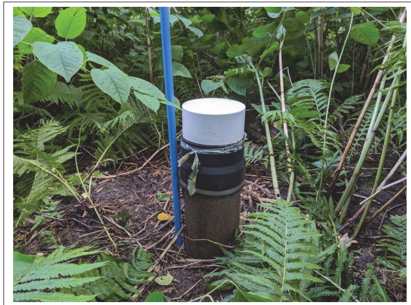
Photo 14 : Vue du piézomètre 2 pour le puits Victoriaville (17 septembre 2020)
