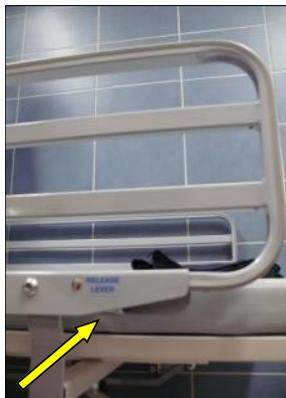
Pour utiliser la barrière de protection latérale, il faut actionner le levier situé sous la barre.
